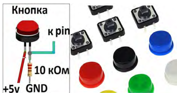
Рис. 1. Схема подключения тактовой кнопки к микроконтроллерной плате
