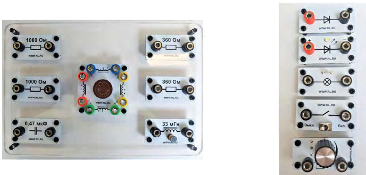
Рис. 17. Дополнительные элементы электрических цепей
