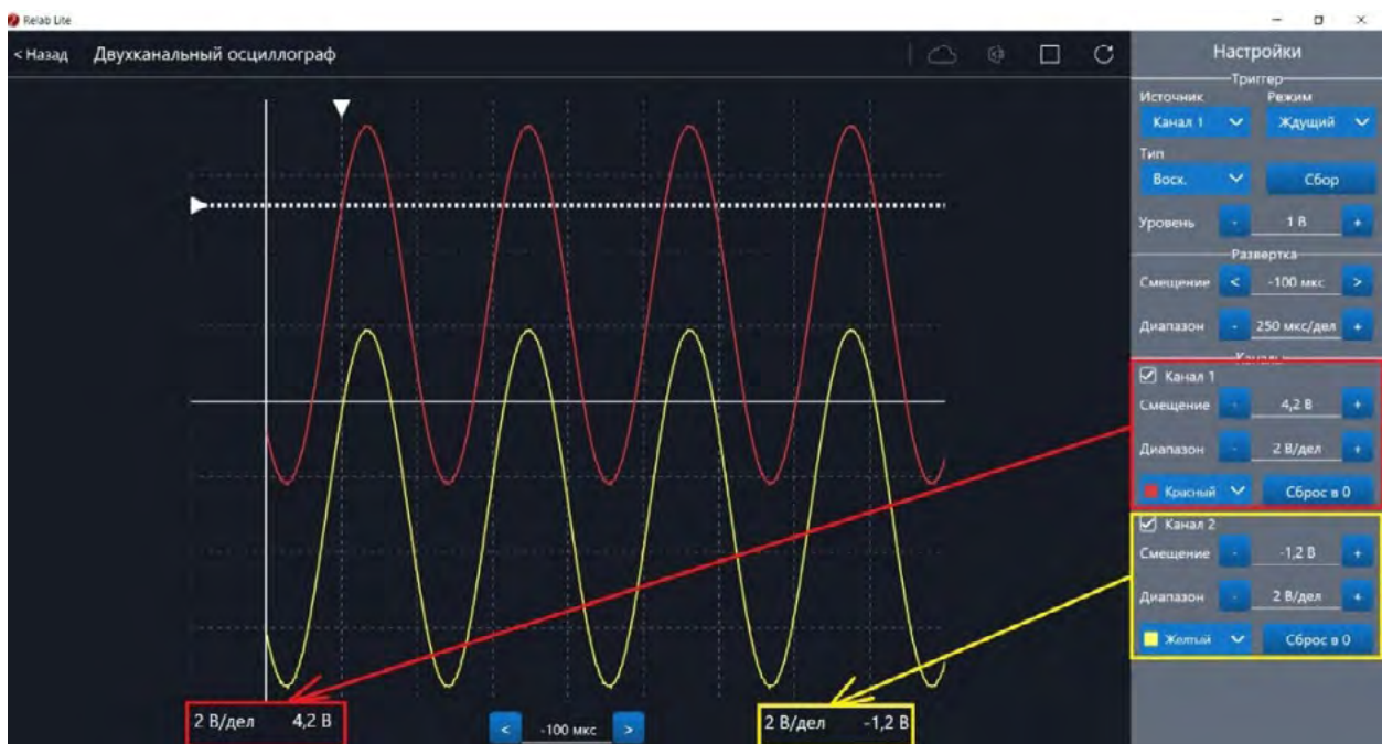
Рис. 39. Использование блока Каналы
